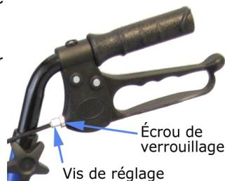
**Remarque :** Si les freins sont trop lâches, les roues continueront de tourner lorsque vous appliquerez les freins. Si le câble est trop serré, les freins ne se verrouilleront pas.
